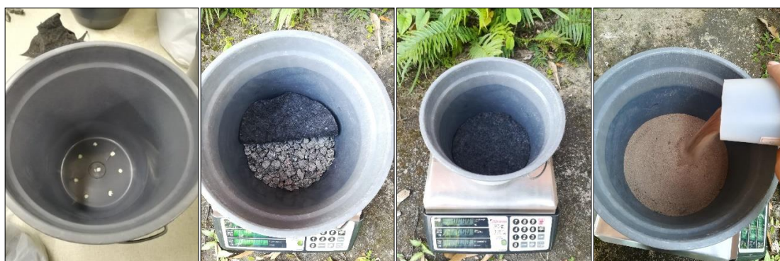
Figura 2. Esquema da montagem do conjunto (vaso, brita, bidim e solo).
