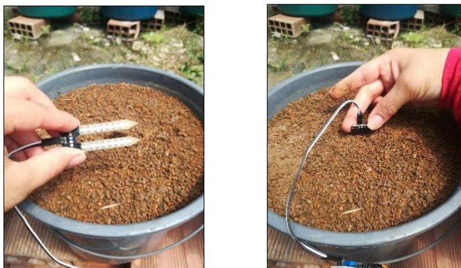
Figura 3. Instalação dos sensores YL-69.
