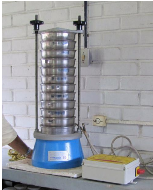
Figura 10 - Amostrador eletromagnético Viatest VSM 200
