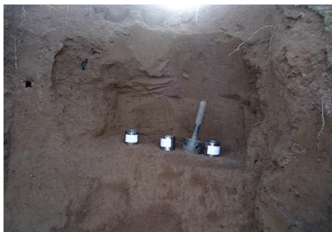
Figura 8 – Amostrador com anéis de Kopeck na profundidade de 40 a 60 cm.
