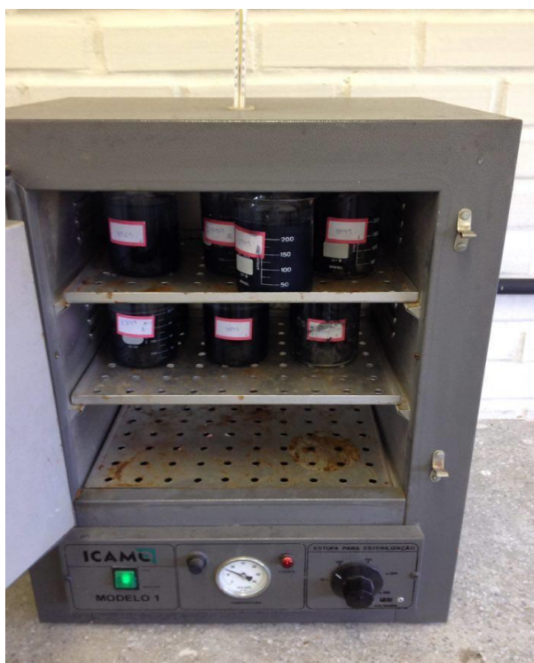
Figura 9 - Processo de secagem do lodo residual.
