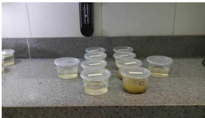
Figura 10: Ensaio ecotoxicológico com sedimento utilizando H. azteca em ambiente refrigerado.
