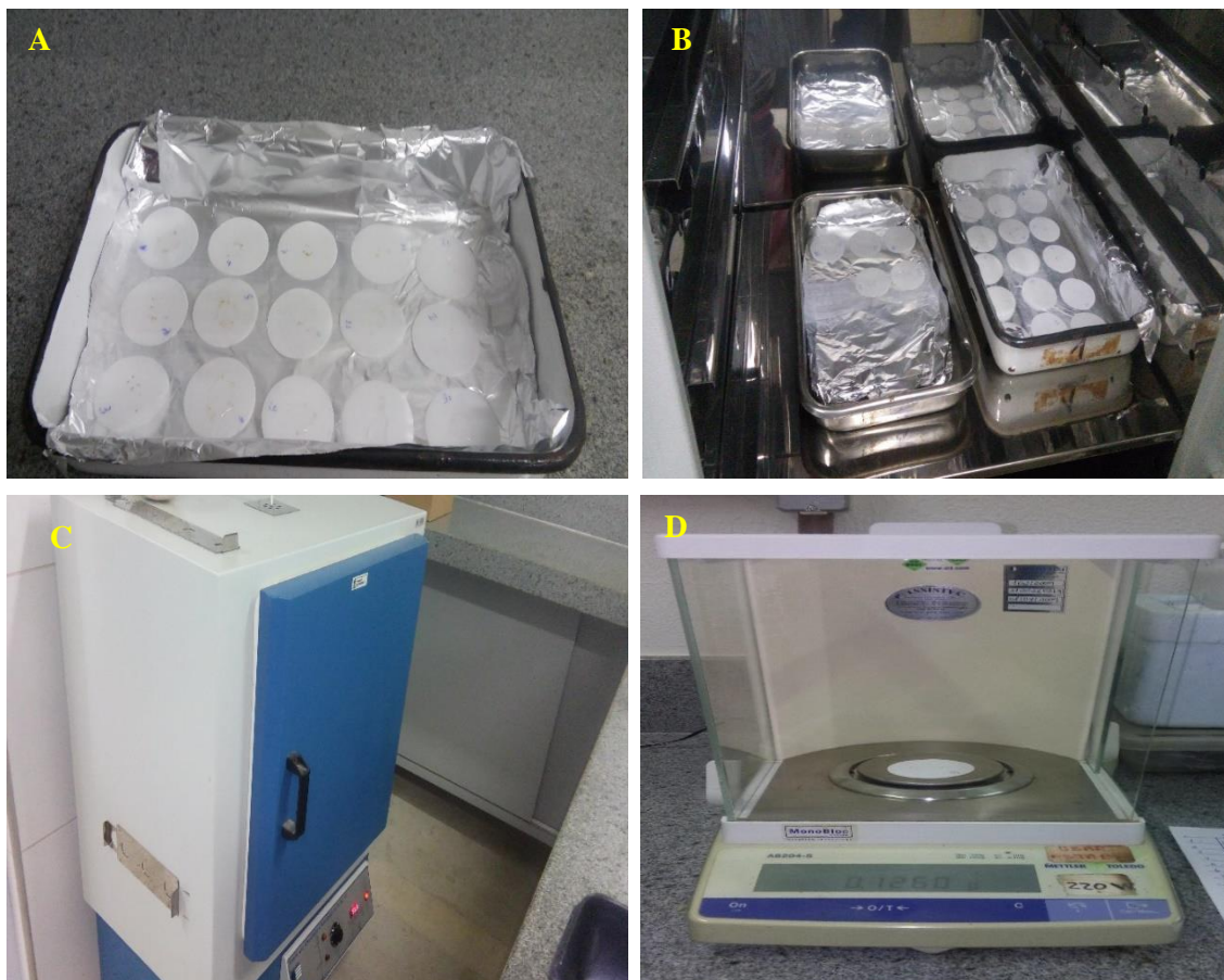
Figura 11: A- Preparação dos organismos para processo de secagem em membranas; B- Organismos disposto em bandejas de alumínio e colocados em estufa; C- Processo de secagem dos organismos em estufa a 60° C por 12 horas; D- Pesagem das membranas em balança analítica.
