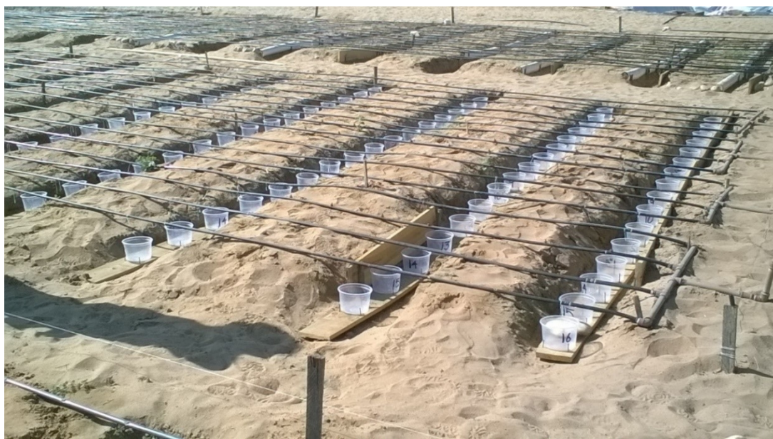
Figura 4. Sistema de trincheiras, tábuas e recipientes coletores numerados para a obtenção da água aplicada por cada gotejador.
