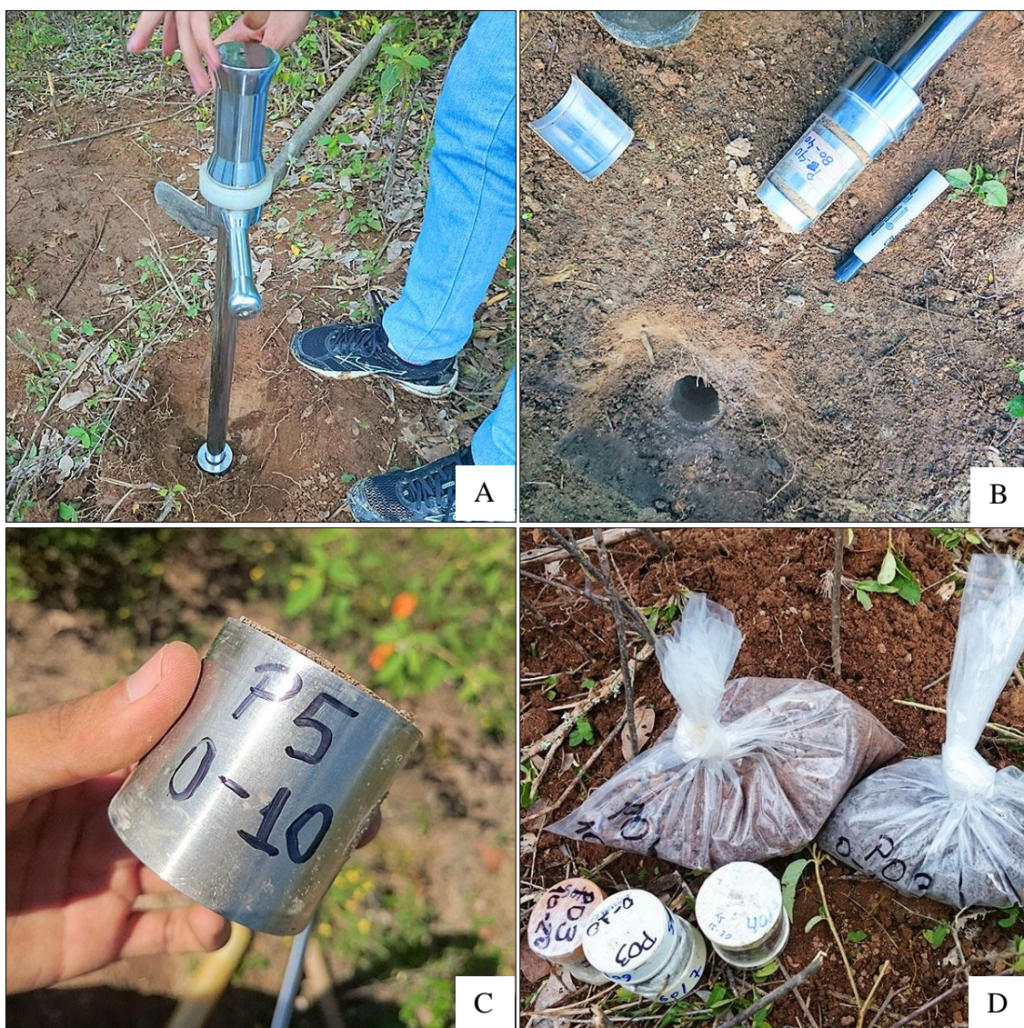
Figura 6. Etapas de amostragem de solo na bacia do Jatobá. (A) coleta de amostra indeformada; (B) cilindro no amostrador após a coleta; (C) amostra indeformada pronta para ser embalada; (D) amostras indeformadas e deformadas, devidamente protegidas.
