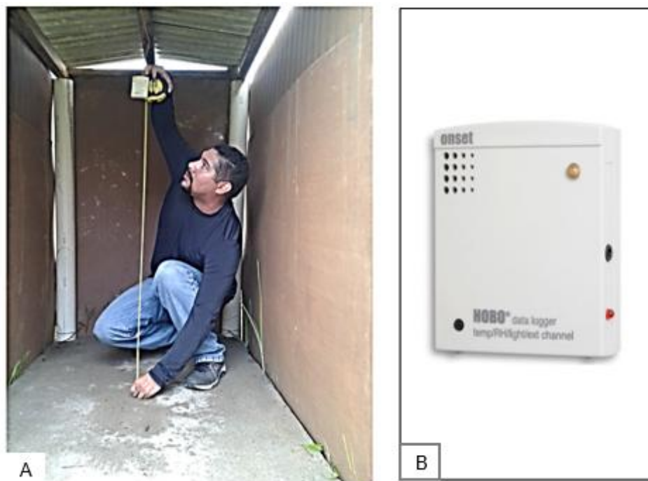
Figura 8. Sensor no centro geométrico no interior do modelo reduzido (A); Datalogger (B).
