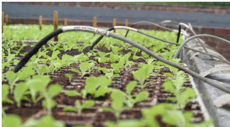
Figura 8 - Termistores inseridos no substrato das células de cultivo.
