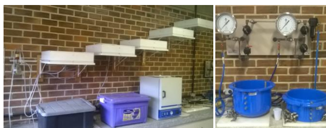
Figura 1. Vista da mesa de tensão (à esquerda) e câmara de Richards (à direita), utilizadas para confecção da curva de retenção de água no solo.
