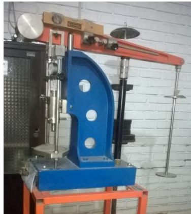
Figura 4. Vista da prensa de adensamento Solotest tipo Bishop, com relação 1:10.
