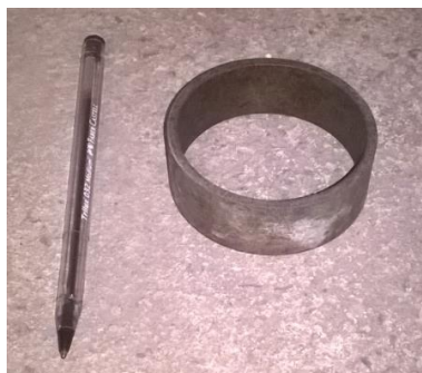
Figura 3. Vista do cilindro metálico para coleta de amostra não deformada com diâmetro de 0,065 m e altura de 0,025 m, do ensaio de compressibilidade.
