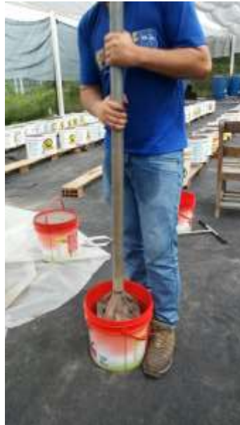
Figura 4. Montagem e compactação dos tratamentos.
