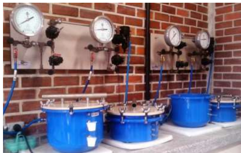
Figura 7. Câmaras de Richards. Laboratório de Dinâmica de água do Departamento de Engenharia Agrícola da UFRPE.
