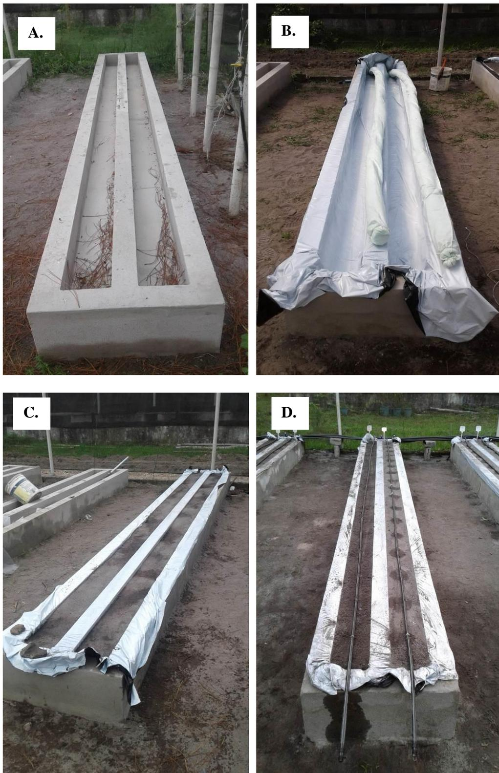
**Figura 1.** Detalhe do canteiro duplo (A), vista da instalação da drenagem (B), unidade experimental com substrato (C), teste do sistema de irrigação: aplicação contínua a esquerda e pulsos a direita (D).
