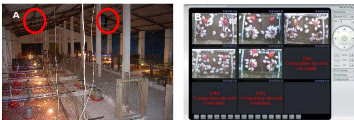
Figura 3. Distribuição das câmeras no interior do galpão para o monitoramento comportamental das aves (A) e Software TOPWAY® usado para o armazenamento das imagens no computador (B).
