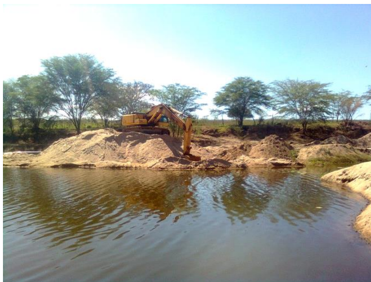
FIGURA 6 - Extração de areia no leito do rio Capibaribe na altura da Fazenda Paraíso
