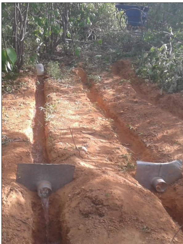
Figura 13 - Simulação do escoamento superficial concentrado realizado durante o experimento de erosão em canais pré-formados
