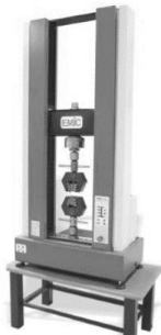
Figura 01: Máquina Universal de Ensaio EMIC DL 1000
