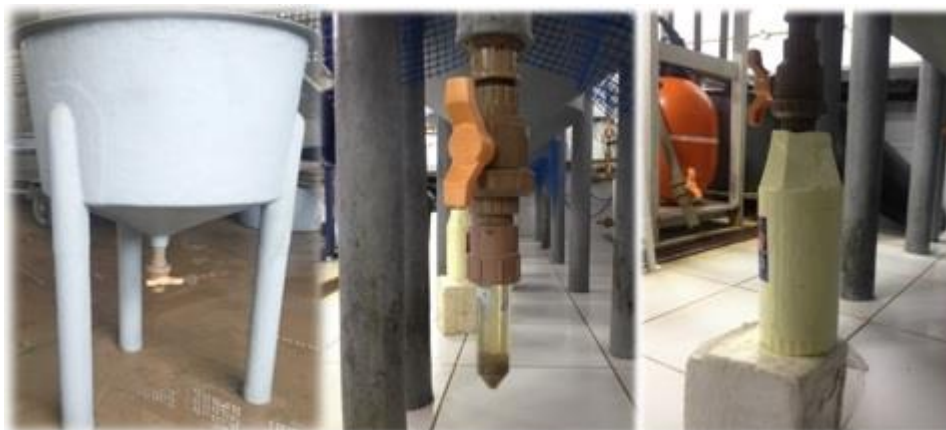
Figura 2 – Tanque digestibilidade cilíndrico cônico com tubo coletor de fezes imerso em gelo.
