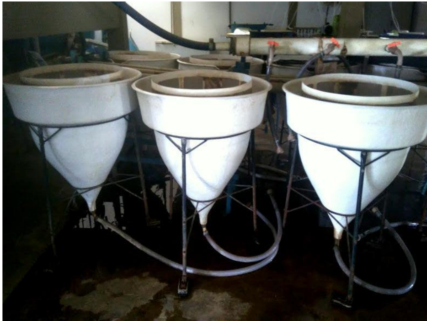
Figura 3. Incubadoras de fibra de vidro com capacidade de 120 L utilizadas no estudo. Foto: LAGA/UFRPE
