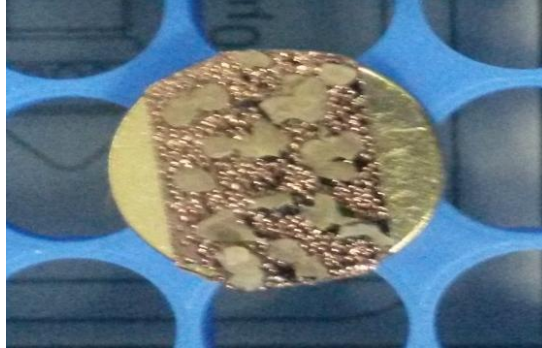
Figura 33 - Metalização das cápsulas
