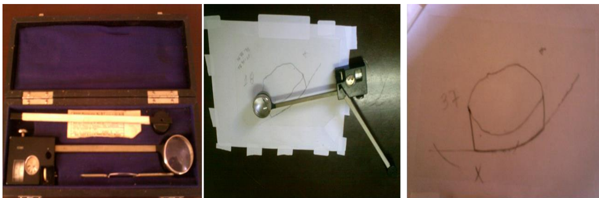
Figura 5. Planímetro e medida de área de olho de lombo e área de gordura.
