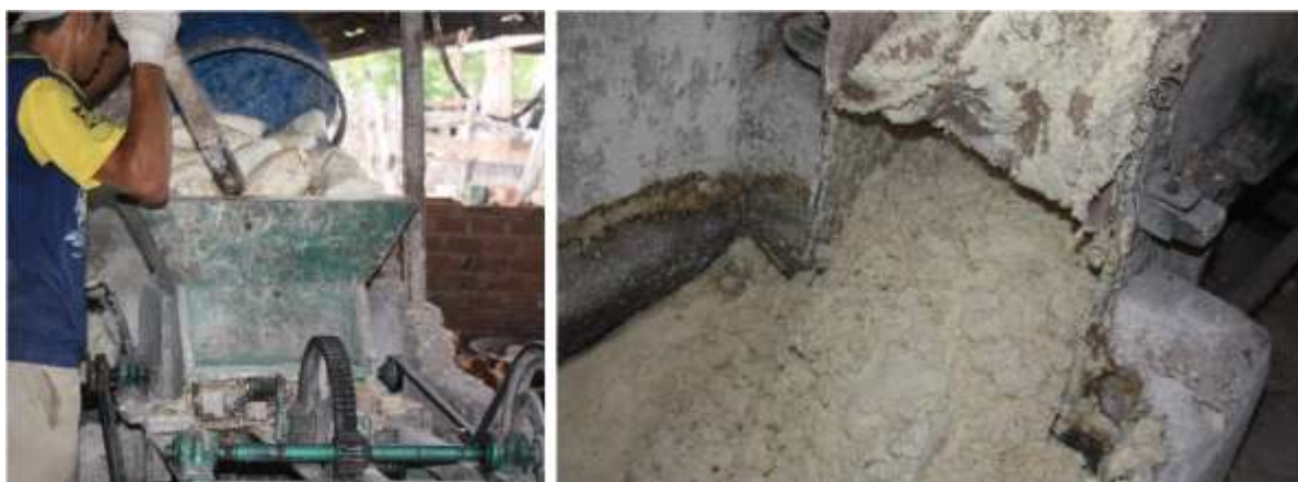
Moinho tipo rodete e massa extraída da operação de moagem das raízes integrais de mandioca ( Manhiot sculenta Crantz).
