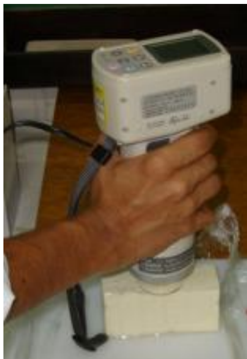
Figura 2- Avaliação da cor instrumental com colorímetro Minolta modelo CR-400, utilizando o sistema CIELAB
