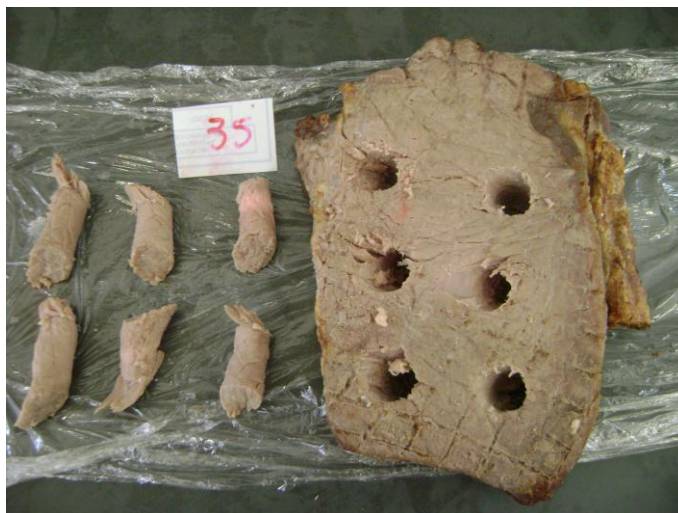
Figura 24. Média dos valores de seis cilindros usados para avaliação da força de cisalhamento
