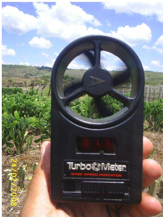
Figura 2 – Anemômetro Digital
