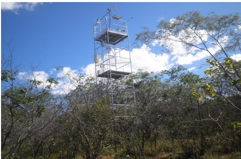
Figura 3. Torre para medição de fluxos turbulentos de energia instalada na área de caatinga na fazenda Buenos Aires, município de Serra Talhada- PE.
