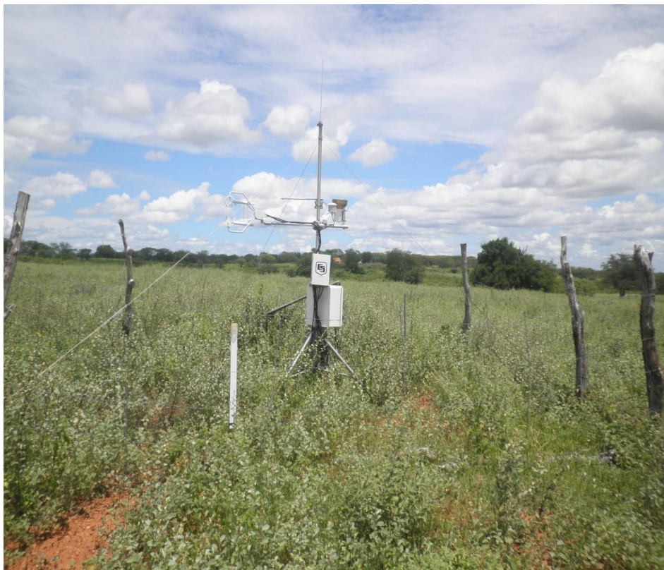
Figura 2. Torre para medição de fluxos turbulentos de energia instalada na área de pastagem na fazenda Lagoinha, município de Serra Talhada- PE.
