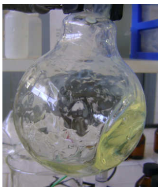
Figura 21. Lariat -éter coroa obtido a partir da reação do APTS e TEG.
