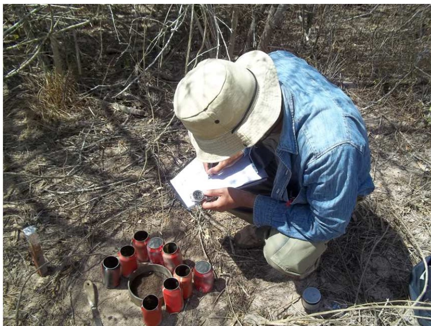
Figura 4. Procedimento do ensaio de infiltração
