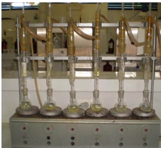
Figura 19. Análise laboratorial de extrato etéreo de amostras experimentais
