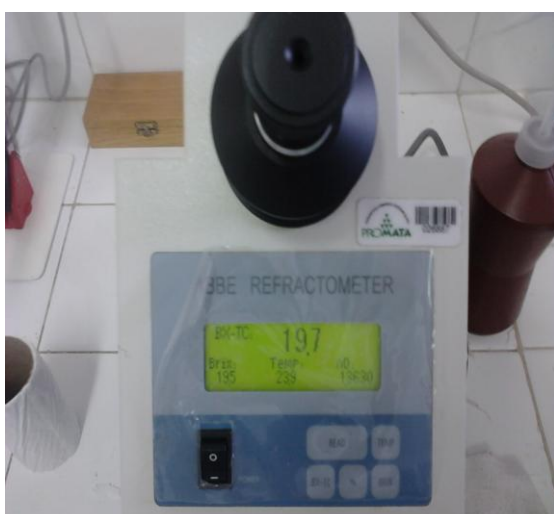
Figura 15. Análise laboratorial do grau brix de cana-de-açúcar através de refratrômetro digital
