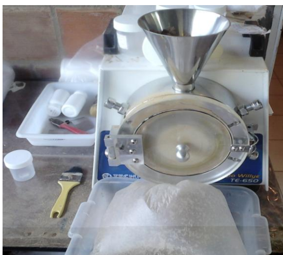
Figura 14. Processamento de amostras em moinho tipo Willey
