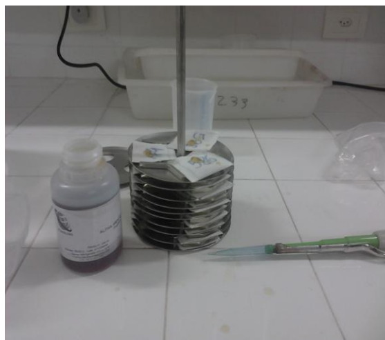
Figura 16. Análises de alimentos de fibra em detergente neutro utilizando alfa amilase
