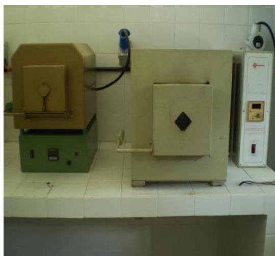
Figura 18. Análise de cinzas de amostras experimentais em mufla
