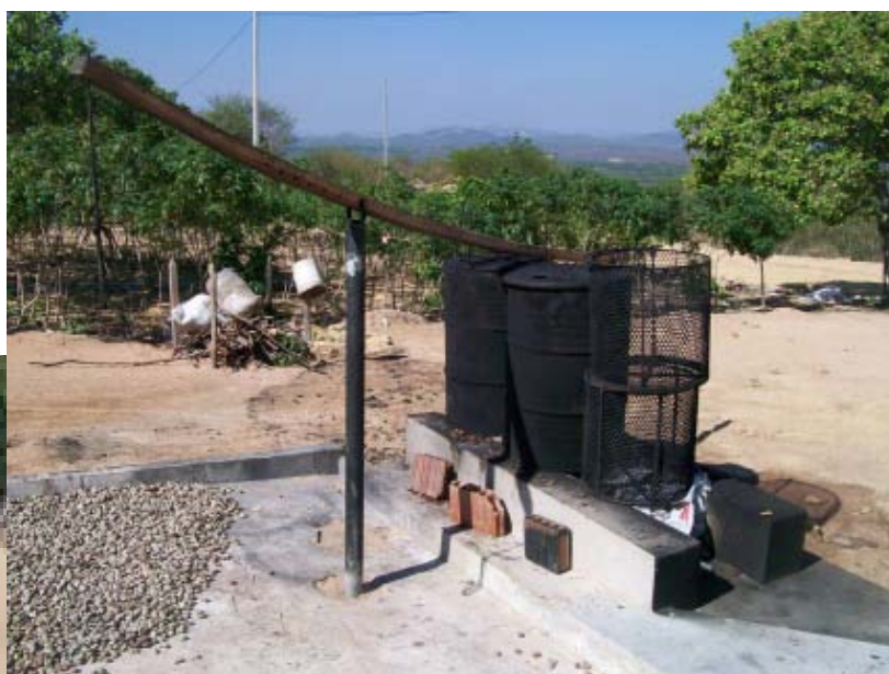
Engenhoca para retirada dos cestos com 40 kg de castanha
