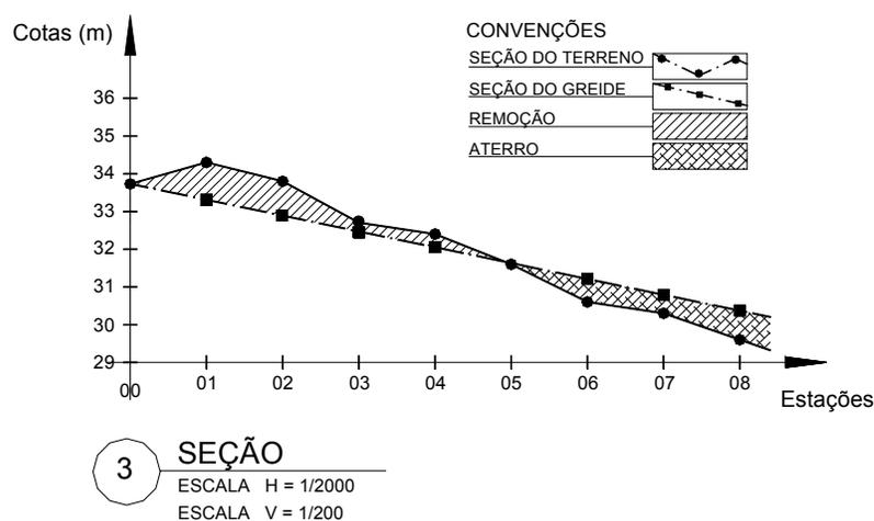
Figura 5 – Seção de um terreno usado na elaboração de um projeto de uma estrada.
