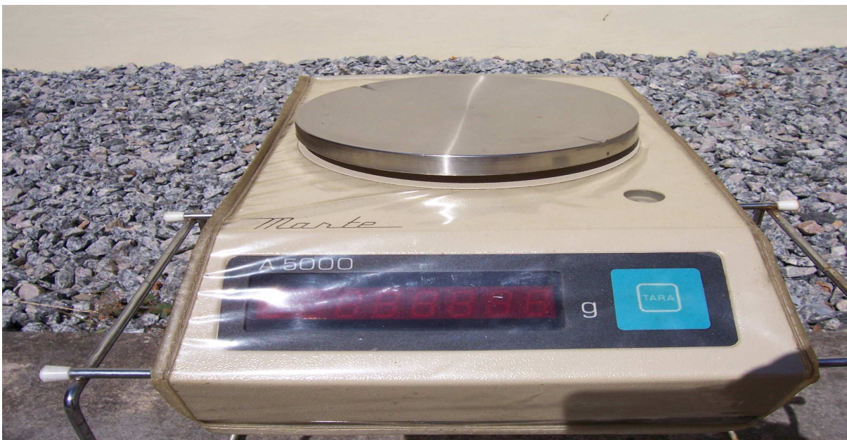
Figura 10 – Vista da balança eletrônica marca Marte modelo 5000, utilizada durante a pesquisa, para pesagem dos ovos e da ração.
