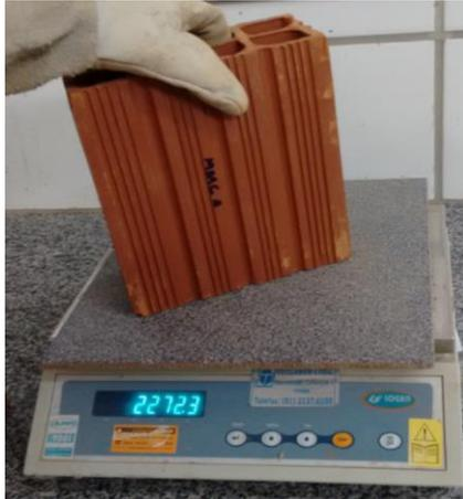
As amostras secas em estufa foram submetidas a um tanque com água, onde permaneceram totalmente imersas durante um período de 24h (Figura 18). Em seguida, as amostras foram retiradas do tanque, das quais removeu-se o excesso de água e prosseguiu-se com a pesagem de cada uma, obtendo a massa úmida ( $m_u$ ). Deve-se atentar para que o tempo entre a remoção do excesso de água e o término pesagem não ultrapassasse 15 minutos (ABNT, 2005b).
