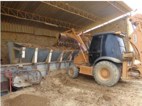
**Figura 5 – Desintegrador**
