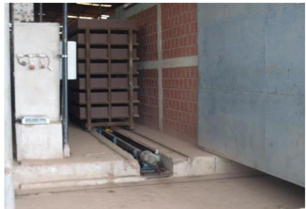
Essa é uma das etapas mais importantes na fabricação de peças de cerâmica vermelha, devendo, portanto, ser monitorada para que a água contida no produto seja retirada de forma lenta e uniforme por toda a massa cerâmica, para que não ocorram defeitos como empenamento e trincas (MONTEIRO et al., 2007).
