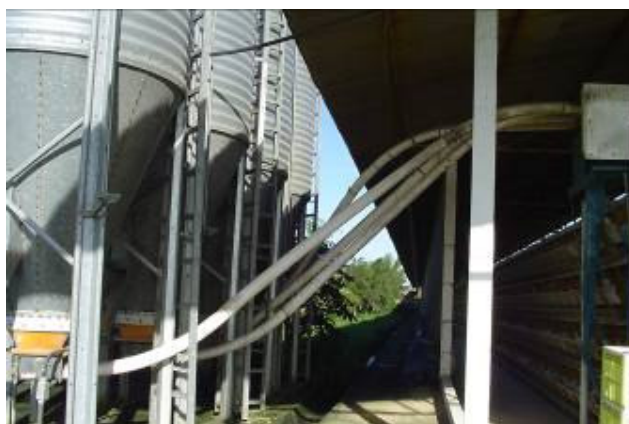
Figura 06: Granja Santa Luzia. Vista da saída da ração do silo para o equipamento de distribuição nas calhas.
