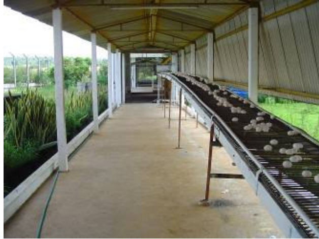
Figura 08. Granja Santa Luzia. Transporte em esteira rolante dos ovos em destino a sala de ovos.
