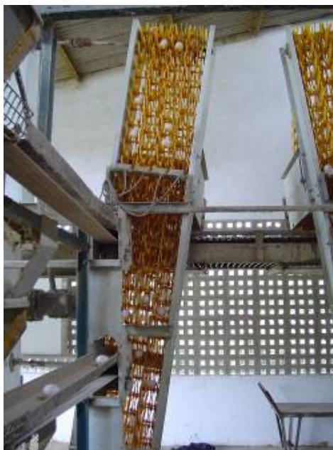
Figura 07. Vista da contagem automática dos ovos produzidos na Granja Santa Luzia.
