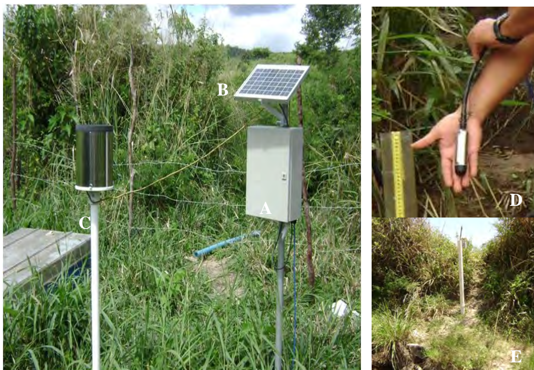
Figura 14. Detalhe da estação fluviométrica instalada na bacia do Riacho Mimoso, constando de Datalogger (A), célula fotoelétrica (B), pluviógrafo (C) e sensor de nível (linígrafo) (D), e poço tranquilizador (E).
