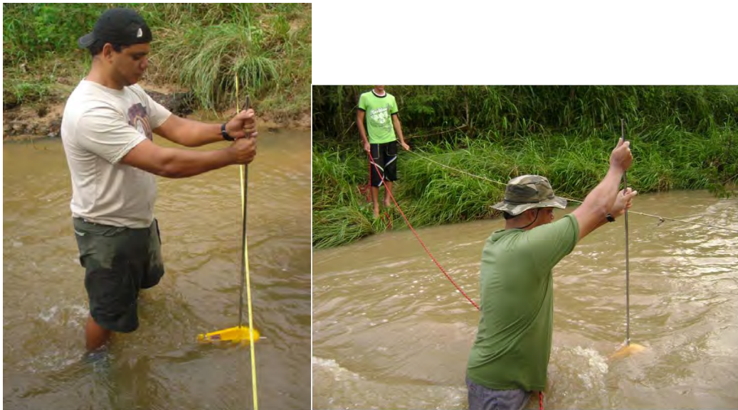
Figura 21. Coleta para determinação da concentração de sedimento em suspensão ( C_{ss} ) utilizando o amostrador DH-48.
