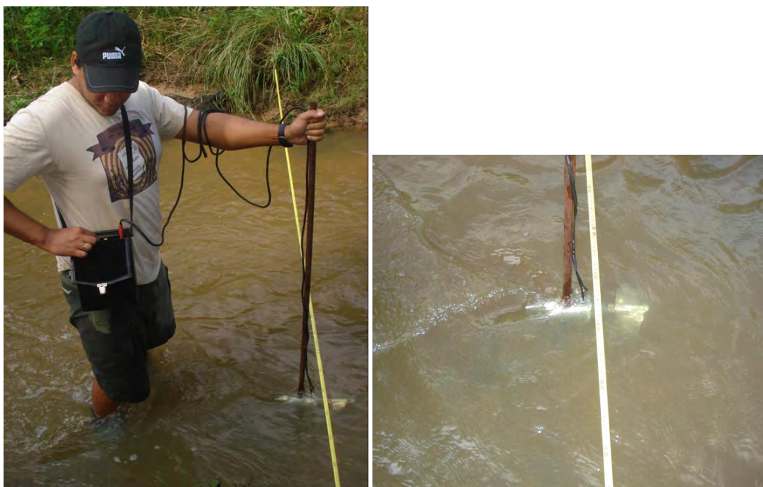
Figura 20. Determinação da velocidade do escoamento utilizando um molinete fluviométrico e contador eletrônico de pulsos.
