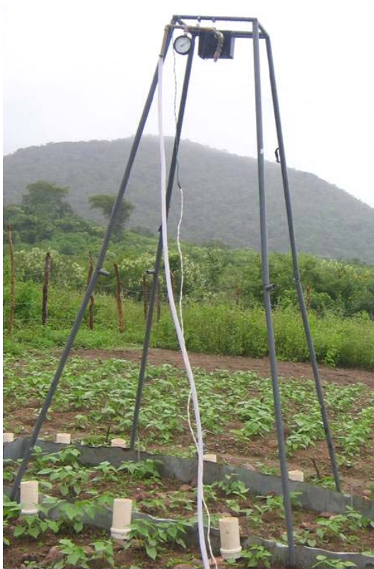
Figura 9. Simulador de chuvas utilizado nos testes de erosão.
