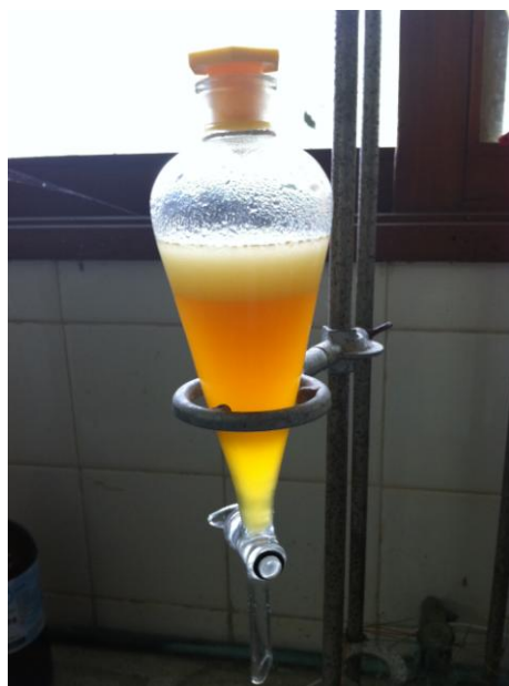
Figura 7 – Funil de separação separando as fases aquosa e clorofórmica (Fonte: Pessoal, 2012).
