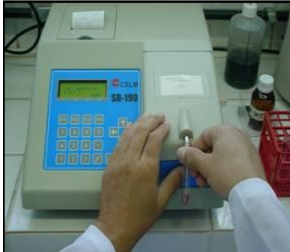
Figura 9: Aspiração de uma amostra pelo sistema de bioquímica semi-automático modelo SB-190.
