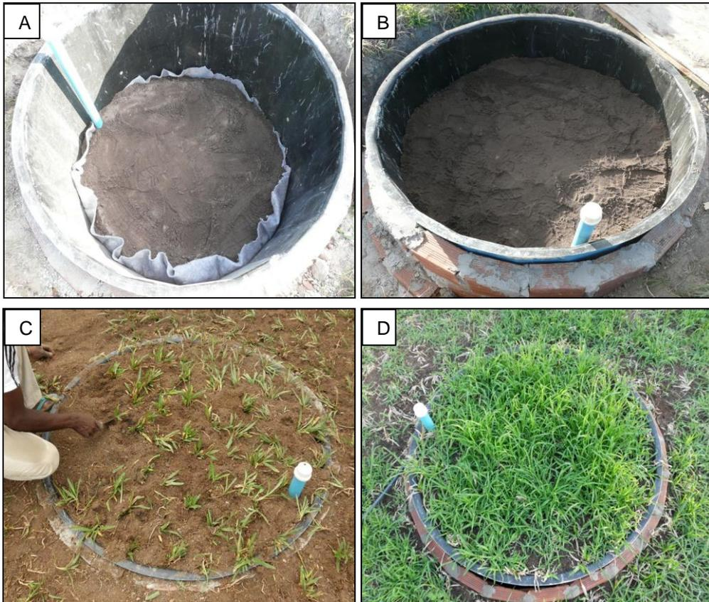
**Figura 3.4.** Fases de preenchimento do lisímetro com solo em ordem de retirada (A e B) e plantio e desenvolvimento da grama Batatais (C e D).
