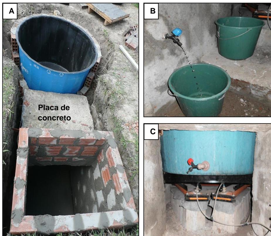
**Figura 3.9.** Vista externa do lisímetro interligado ao túnel de acesso através da placa de concreto (A); Vista interior do túnel de acesso aos drenos dos lisímetros (B) e ao sistema de pesagem hidráulica (C).
