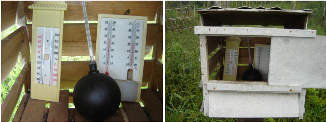
Figura 4 - Vista parcial dos termômetros dentro do abrigo meteorológico.
