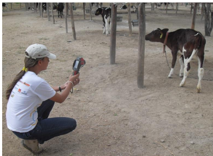
Figura 13. Registro de imagem termográfica para análise térmica da temperatura de superfície do corpo do animal.
