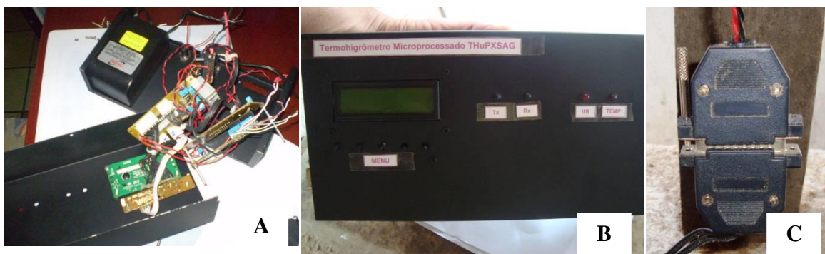
Figura 2 – Montagem do controlador (A), vista frontal do controlador (B), conector DB 25 para comunicação entre o controlador e os atuadores(C).
