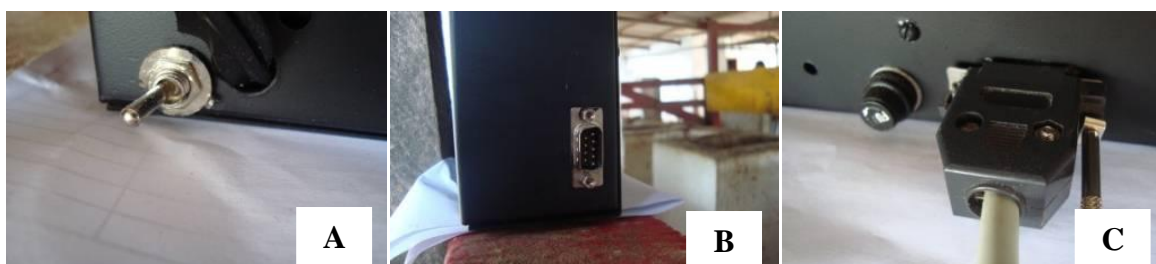
Figura 3 – Chave liga/desliga (A), entrada (DB 9) para programação (B) e comunicação (DB 15) com os sensores(C).
