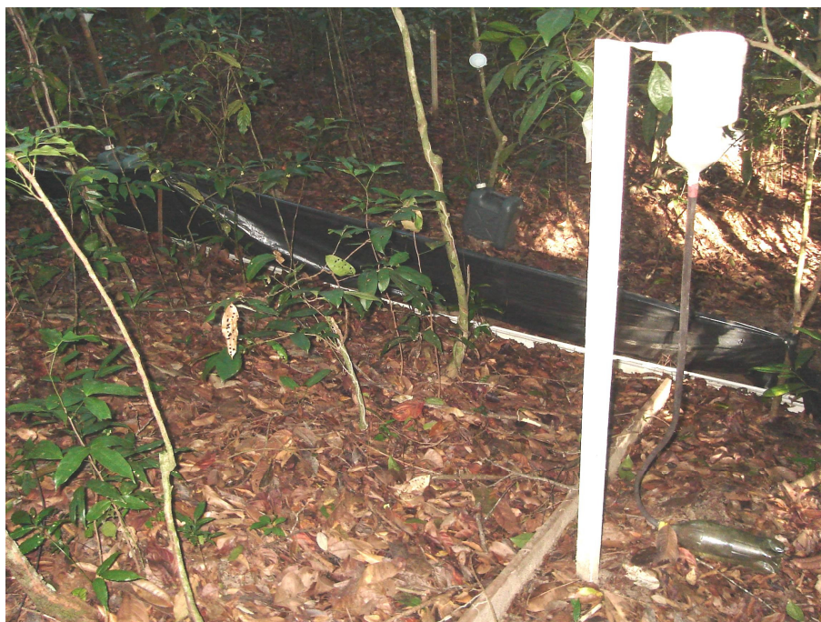
Figura 12. Vista parcial do sistema coletor do escoamento superficial laminar no interior da mata com a cobertura plástica da calha.
