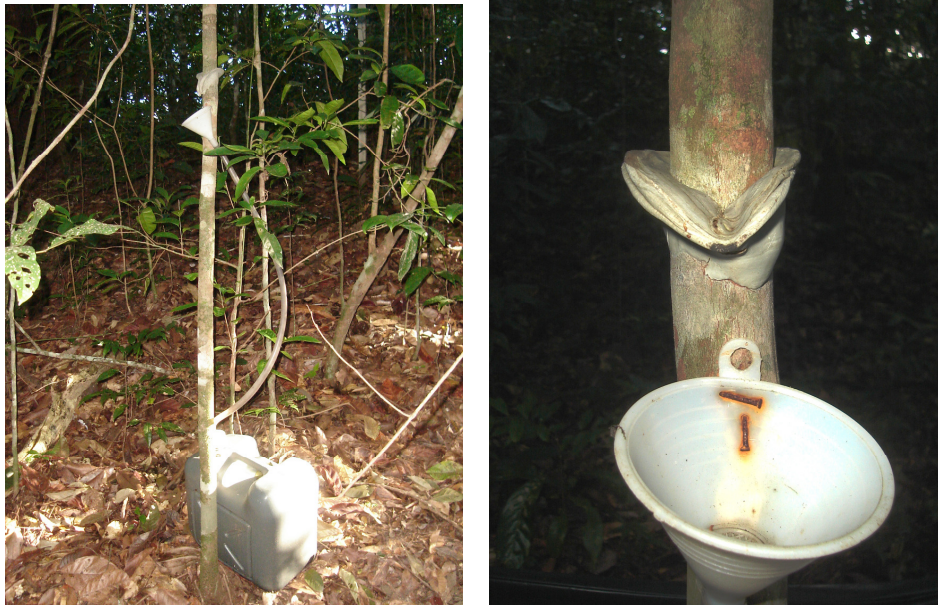
Figura 11. Sistema coletor de água escoada pelo tronco das árvores do sub-bosque
