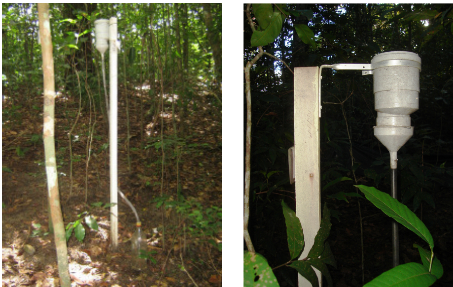
Figura 07. Interceptômetro instalado no interior da mata.
