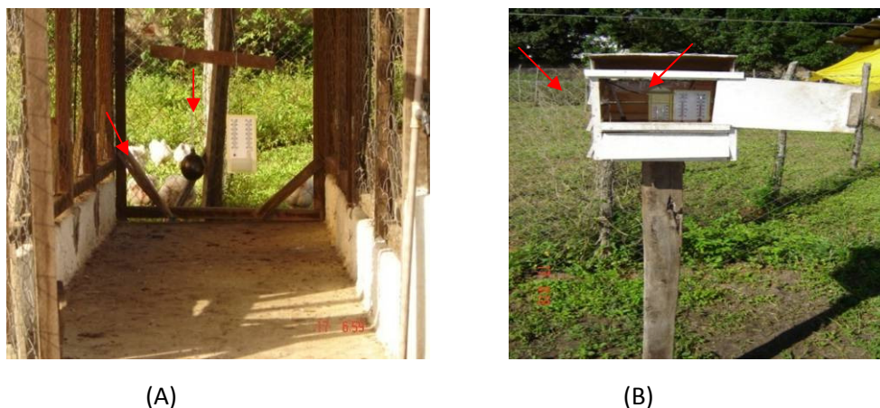
Figura 6 - Registro dos dados meteorológicos dentro do módulo de produção utilizando termo-higrômetro e termômetro de globo negro (A) e registro dos dados ambientais no ambiente externo (B).
