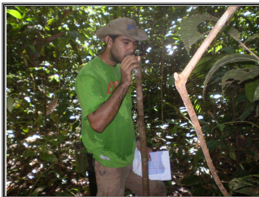
Figura 3. Detalhe do uso da bússola para abertura dos transectos, RDS Uacari, Carauari – AM. (Foto: Edgar Castro).
