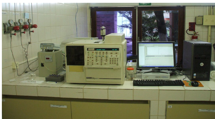
Figura 5 – Da esquerda para direita: na parede, válvulas dos gases; na bancada, fluxímetro, microseringa, amostras de fluido ruminal, cromatógrafo e computador com programa de interpretação da leitura dos ácidos.
