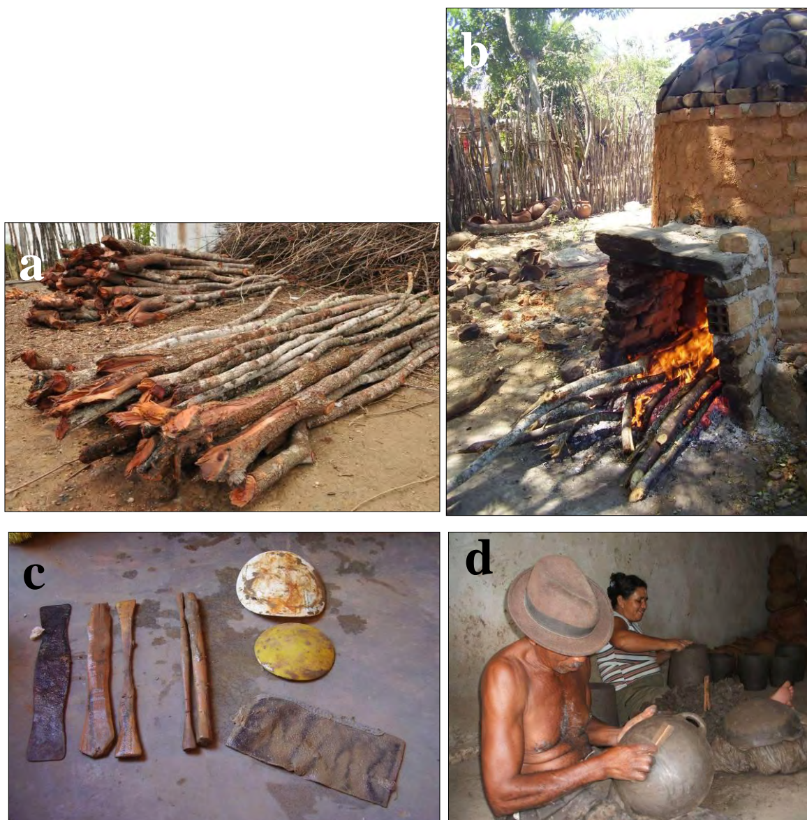
Figura 9. Materiais vegetais utilizados na produção de cerâmica (a) Estacas de madeira de diferentes diâmetros são utilizados na cocção dos vasos; (b) Utilização da madeira no forno; (c) Materiais utilizados no tratamento de superfície dos vasos, entre eles secções transversais de madeira genericamente denominados de “paus”; (d) Ceramista utilizando um desses “paus” para “alisar” uma panela. Fotos: (a) Daniel Tavares; (b) e (c) Raiana Lira; (d) Ângelo Alves.
