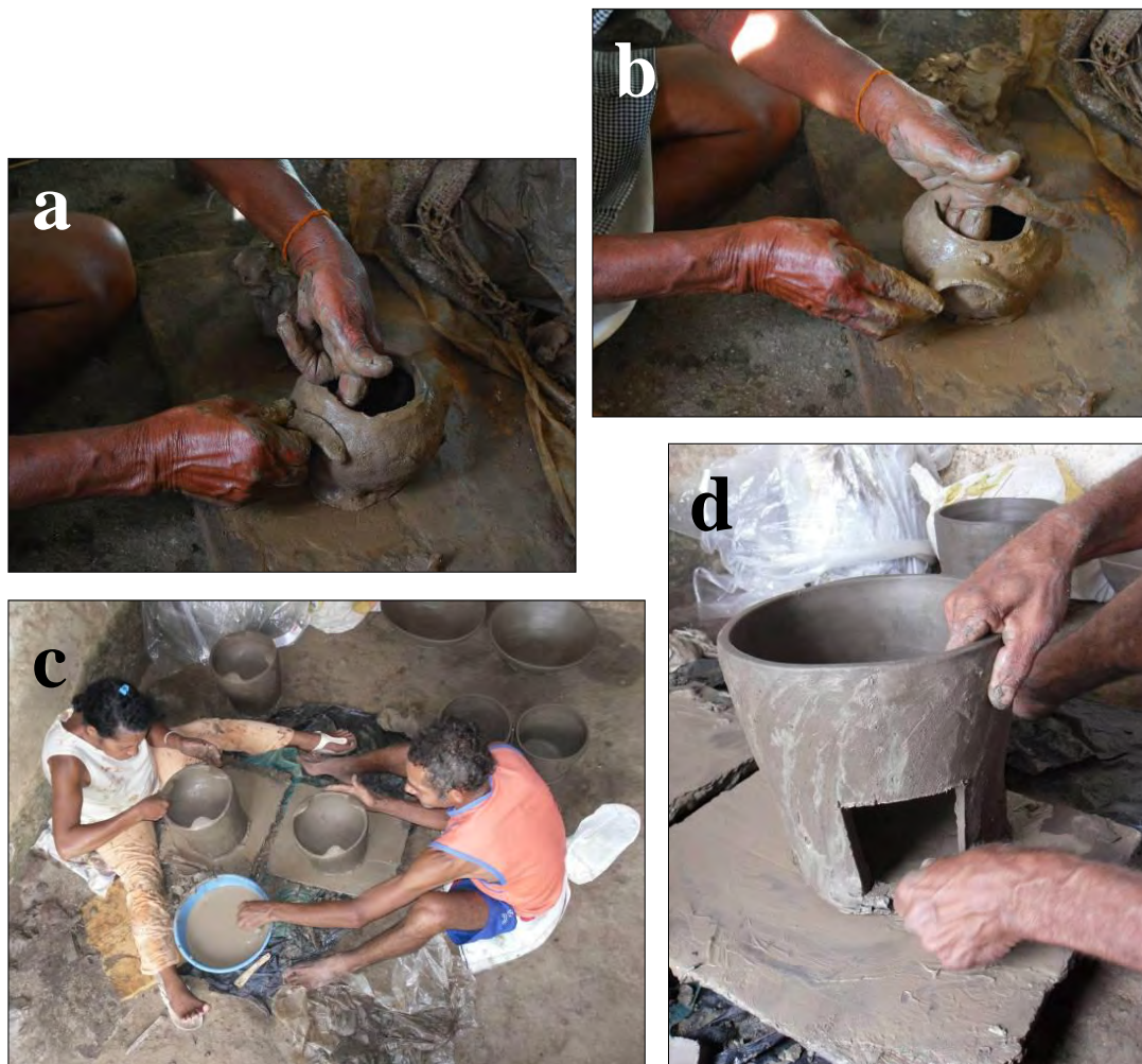
Figura 13. Ceramistas acrescentando estruturas aos vasos (a) Acréscimo da “asa” à panela;(b) Ajuste da “asa” ao corpo da panela; (c) Preenchimento do “fogareiro” e aplicação das abas (d) Abertura quadrada no “fogareiro”. Fotos: (a) (b) Sérgio Bernardo e (c) e (d) Ângelo Alves
