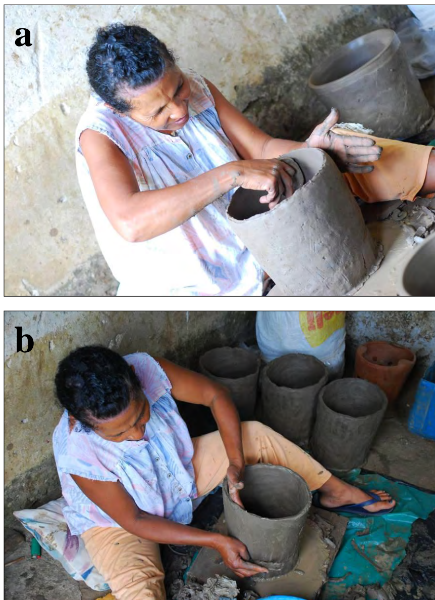
Figura 12. Ceramista fazendo os primeiros tratamentos de superfície. (a) A “palheta” é usada principalmente no interior do vaso, seja para definir a abertura do corpo do vaso, seja para “alisar” o interior; (b) o “pau” é utilizado para uniformizar o vaso e para retirar algumas “pedras” que possam ficar na peça. Fotos: Sérgio Bernardo
