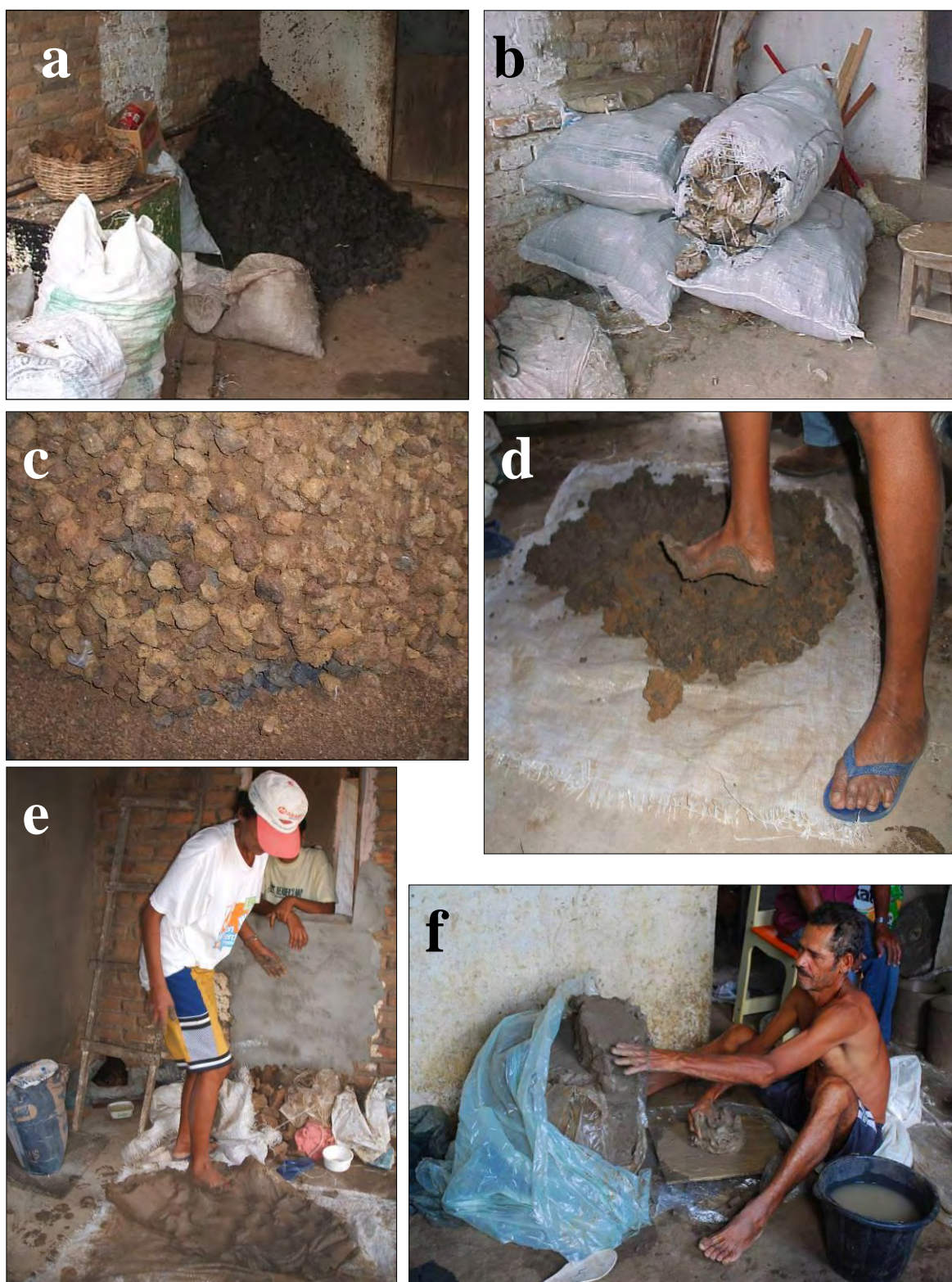
Figura 10. Processamento do barro e composição da pasta. (a) Armazenamento dos materiais de solo em montículos; (b) Armazenamento dos materiais de solo em sacos. (c) Mistura de “barro preto” e “barro vermelho” destorroados e postos em camadas superpostas antes de serem umedecidos; (d) Mistura sendo “pisada” (e) Após um tempo sendo “pisada” é obtido o ponto da pasta; (f) A pasta é armazenada em um “monte” e coberto com plásticos. Fotos: (a) (c) Raiana Lira; (b) (d) (e) Ângelo Alves; (f) Sérgio Bernardo.
