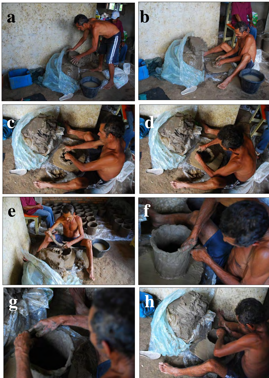
Figura 11. Ceramistas formando o corpo de um vaso: (a) Retirada do “bolo” da pasta; (b) O “bolo” é acomodado numa superfície plana; (c) “Abertura” do bolo com a mão; (d) O “loiceiro” iniciando a formação do corpo do vaso; (e) Aplicação do anel de barro; (f) O rolete é incorporado ao vaso por movimentos ascendentes; (g) e (h) Após a uniformização do vaso o “loiceiro”, através de movimentos suaves fez um refinamento da porção superior do vaso. Fotos: Sérgio Bernardo
