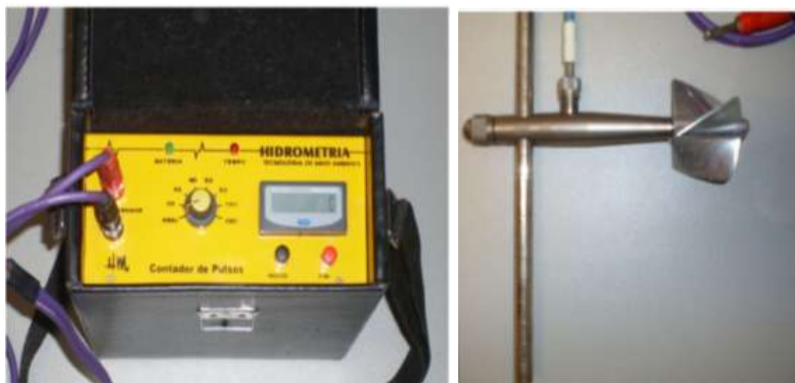
Figura 10 – Contador eletrônico de pulso e hélice do micromolinete.
