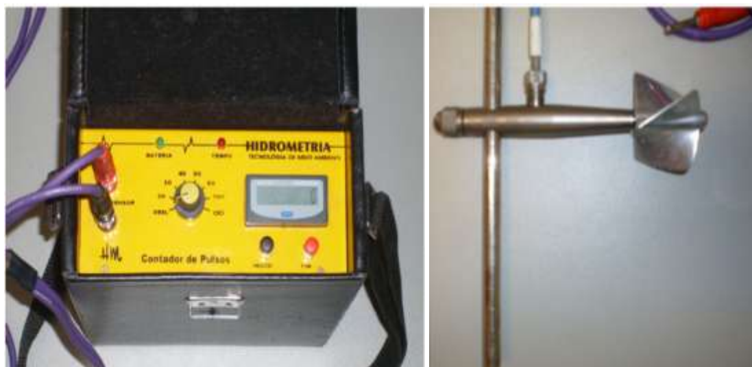
Figura 08 – Contador eletrônico de pulso e hélice do micromolinete.
