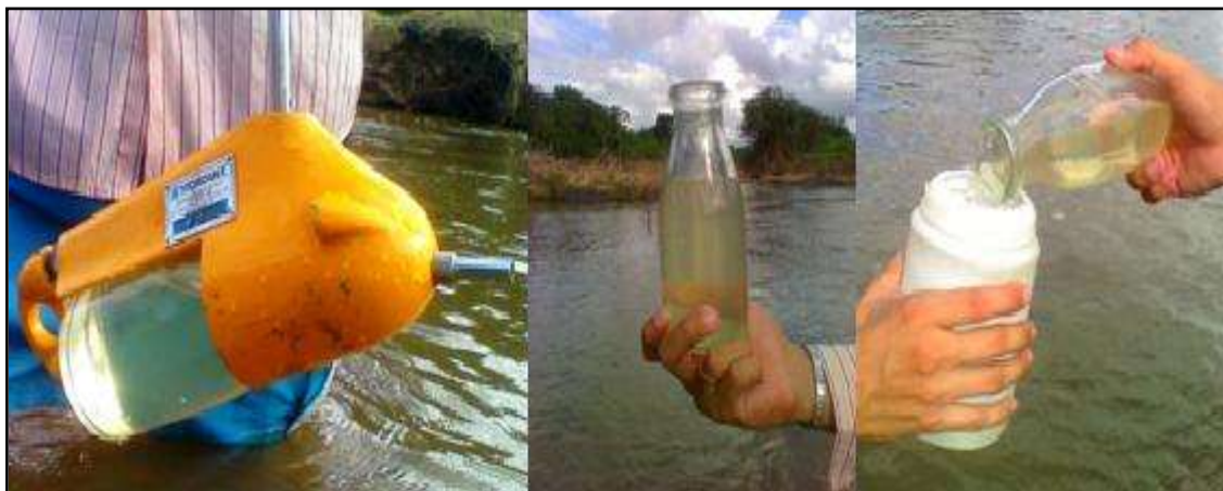
Figura 13 – Coleta e armazenamento das amostras de sedimento em suspensão realizada durante as campanhas de medição direta.
