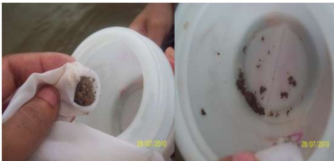
Figura 15 – Condicionamento e quantificação do sedimento de fundo coletado pelo amostrador BLH-84.
