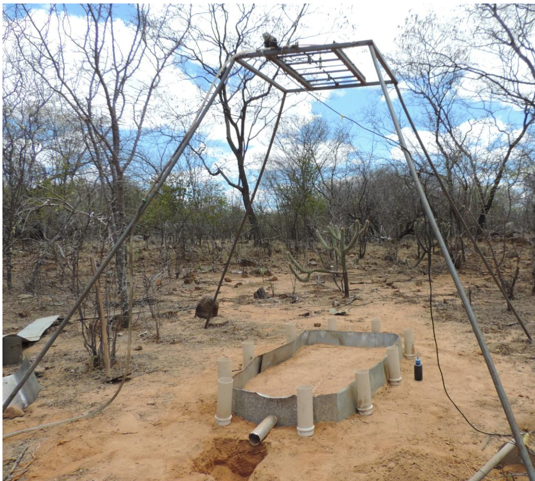
Figura 11: Simulador de chuva utilizado para avaliar as taxas de erosão em entressulcos na bacia hidrográfica do riacho Jacu, Serra Talhada-PE.
