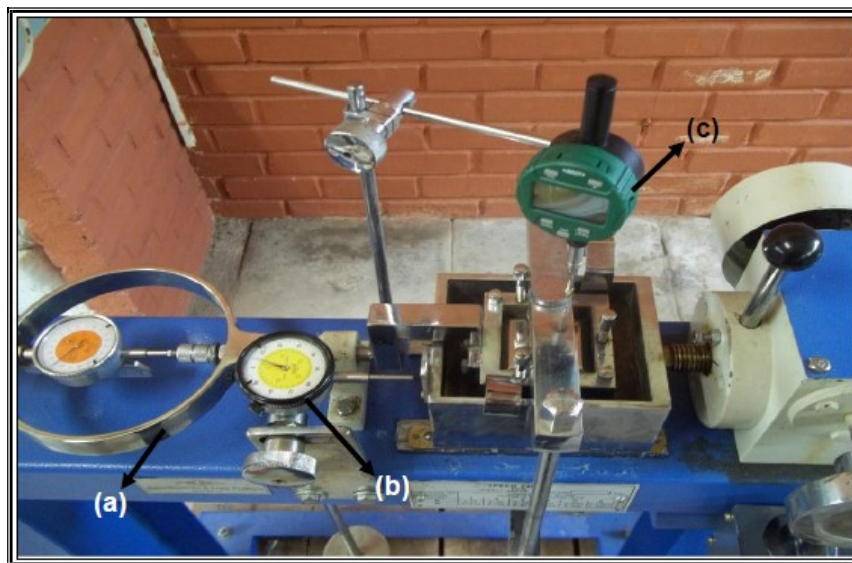
Figura 14; Detalhe do aparelho de Cisalhamento Direto e o anel dinamométrico e no relógio comparador de deformação vertical. Fonte: Souza (2015).
