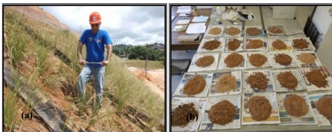
Figura 10; (a) processo de coleta; e (b) secagem das amostras no laboratório.
