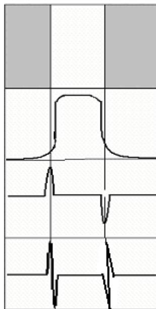
Fig 22 – Uma borda de imagem, o perfil de uma linha horizontal, sua primeira e segunda derivadas.
