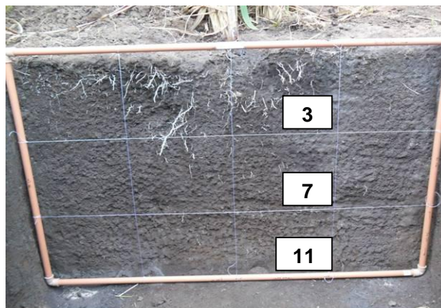
Figura 4. Perfil de solo com delimitação da malha de quadrantes estabelecidos e posições de coleta das amostras de solo para realização das análises químicas nas profundidades 0,0-0,30 m (3); 0,30-0,60 m (7) e 0,60-0,90 m (11).
