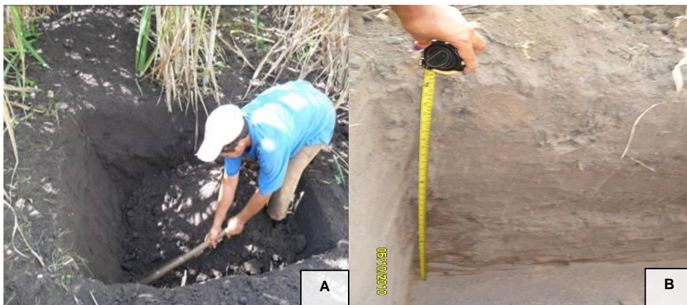
Figura 4. Ilustração da abertura das trincheiras (A) para a obtenção de perfis de solo (B) para avaliação do crescimento do sistema radicular da cana-de-açúcar.
